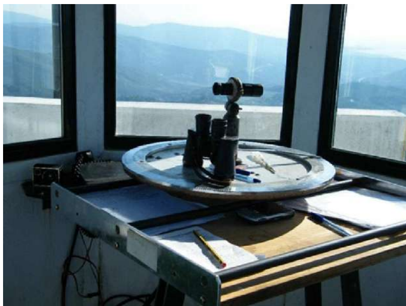
Figura 46 - Goniômetro num posto de vigilância fixa para incêndios florestais, em Vila Nova de Cerveira (Portugal).
