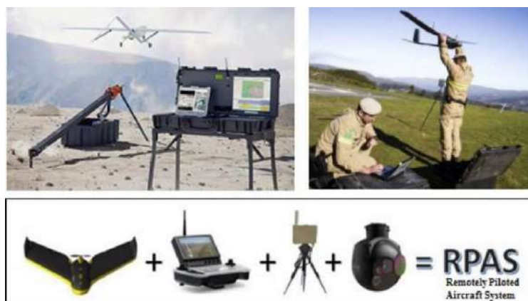
Figura 50 - Componentes que constituem um VANT ou RPAS - Remotely Piloted Aircraft System .
